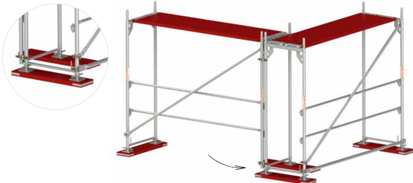
Rys. 29b. Wykonanie narożników za pomocą złączy obrotowych.
