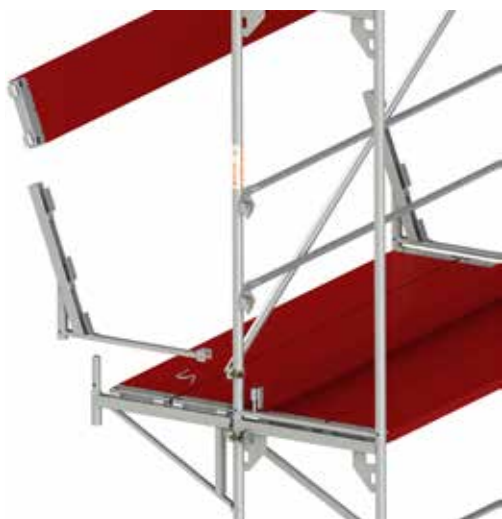
Rys. 17a. Montaż daszków ochronnych zgodnie z normą PN-EN 12811-4:2014-02.
