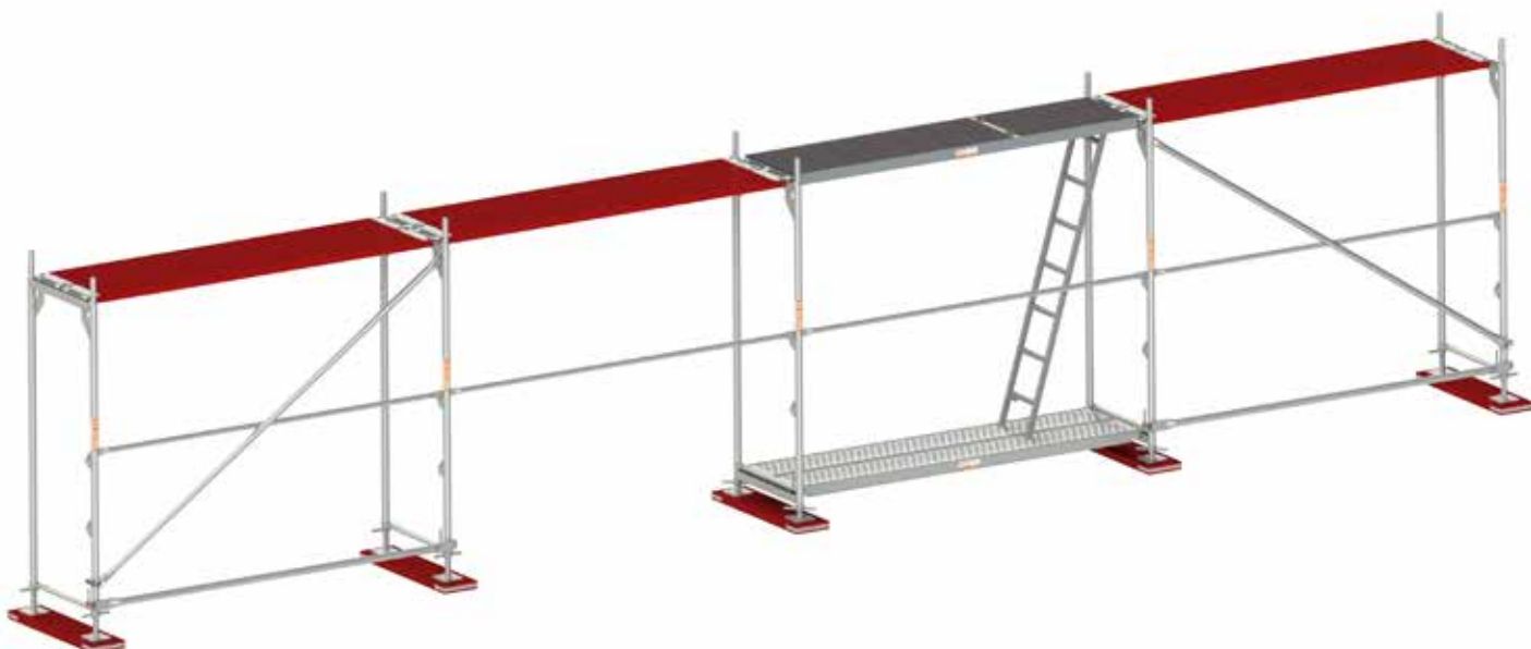
Rys. 6. Zmontowane kolejne pola pierwszej kondygnacji.
