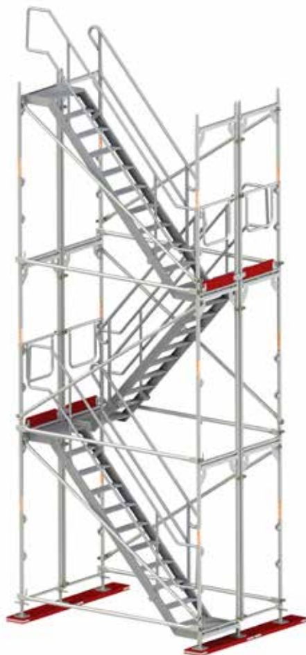
Rys. 45. Montaż klatki schodowej etap VI.
