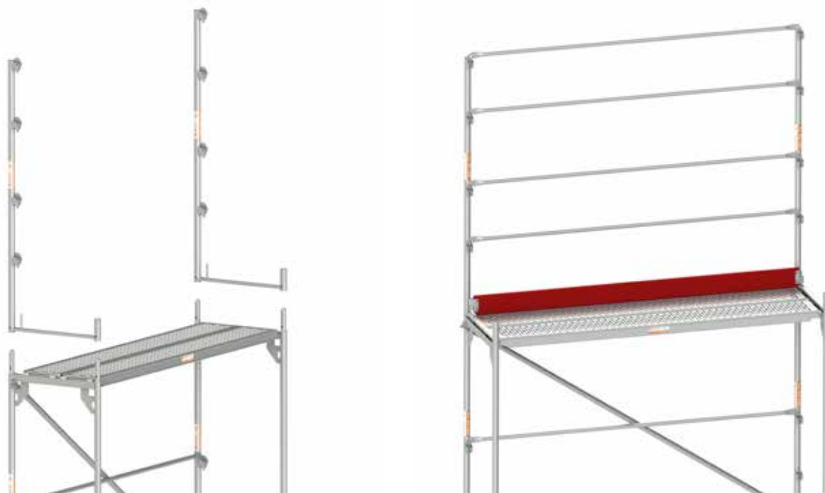
Rys. 18. Montaż słupków dekarSKich.
