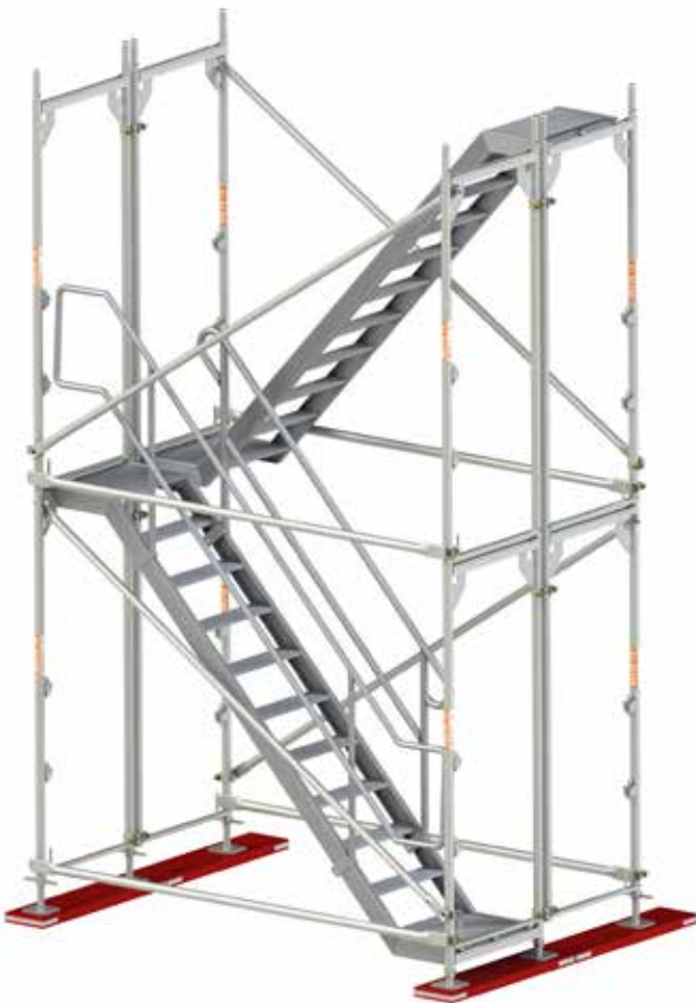
Rys. 42. Montaż klatki schodowej etap III.
