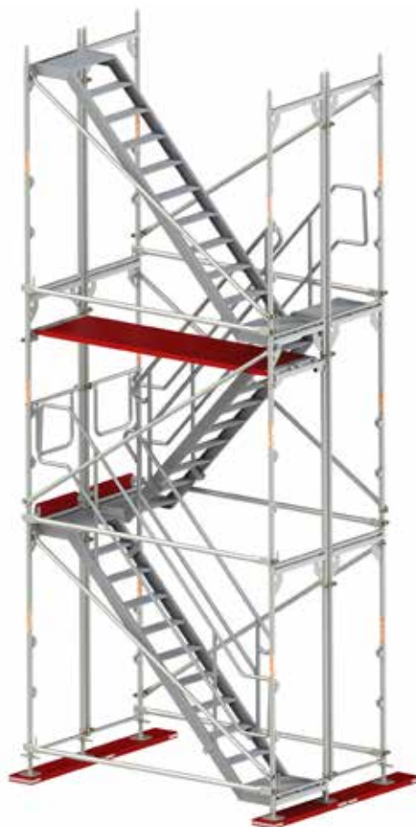
Rys. 44. Montaż klatki schodowej etap V.
