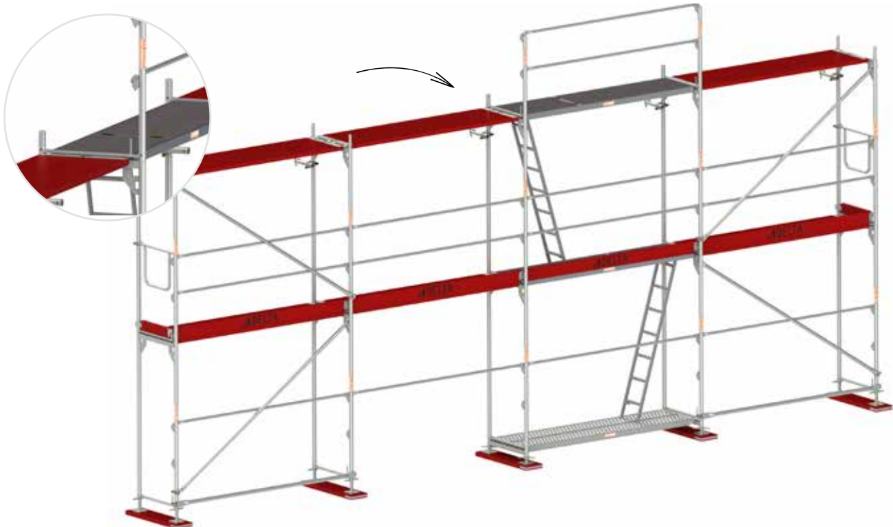
Rys. 10. Montaż słupków poręczowych z zabezpieczeniem pomostów.
