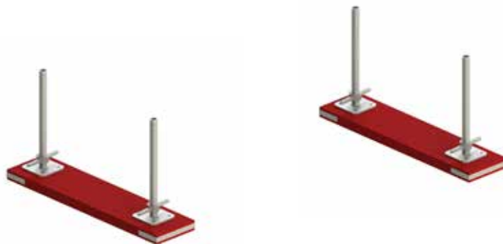
Rys. 2a. Posadowienie rusztowań na podkładach drewnianych.
