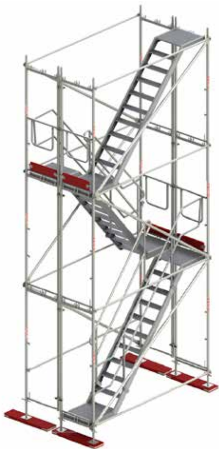
Rys. 45. Montaż klatki schodowej etap VI.
