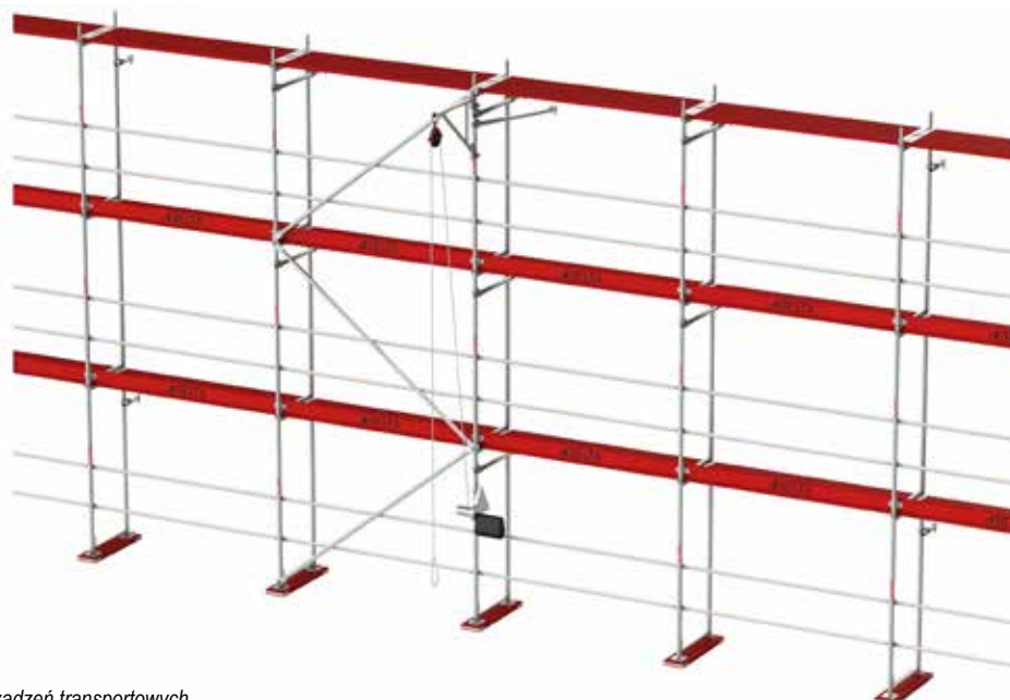
Rys. 32. Montaż urządzeń transportowych.
