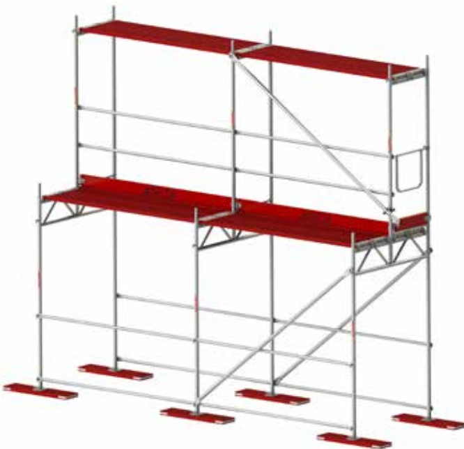
Rys. 26a. Rama przejścia 1,50 m.
