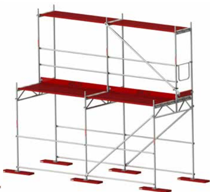
Rys. 26b. Rama przejścia 1,80 m.
