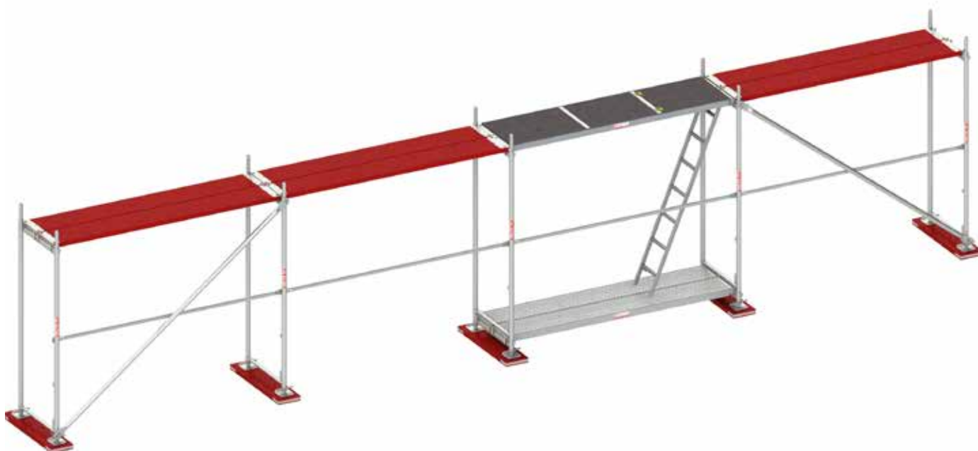
Rys. 6. Zmontowane kolejne pola pierwszej kondygnacji.
