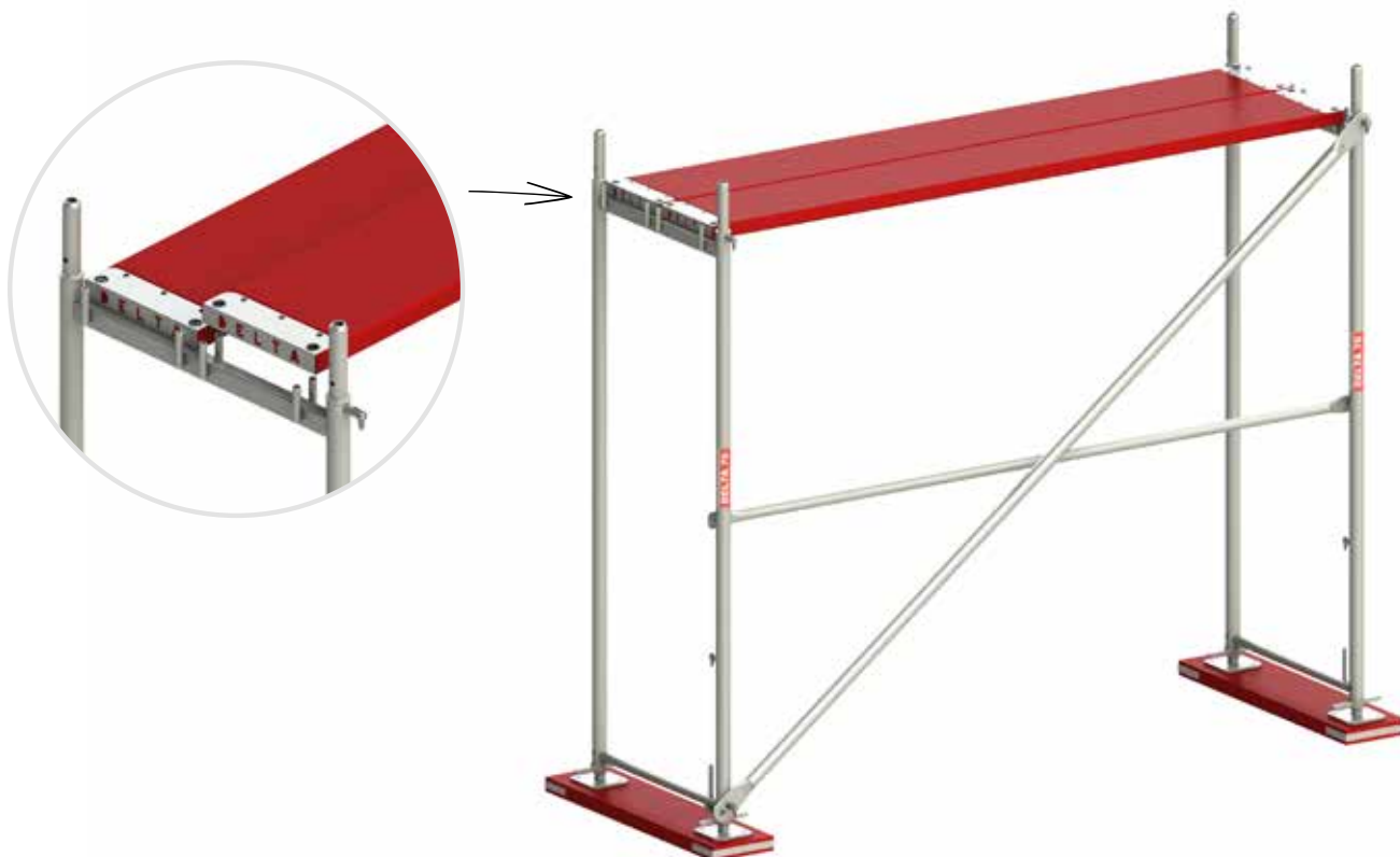
Rys. 5. Zmontowane pole bazowe pierwszej kondygnacji.
