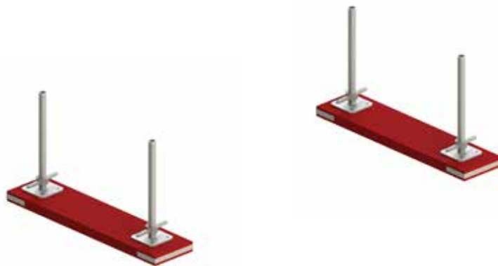
Rys. 2a. Posadowienie rusztowań na podkładach drewnianych.
