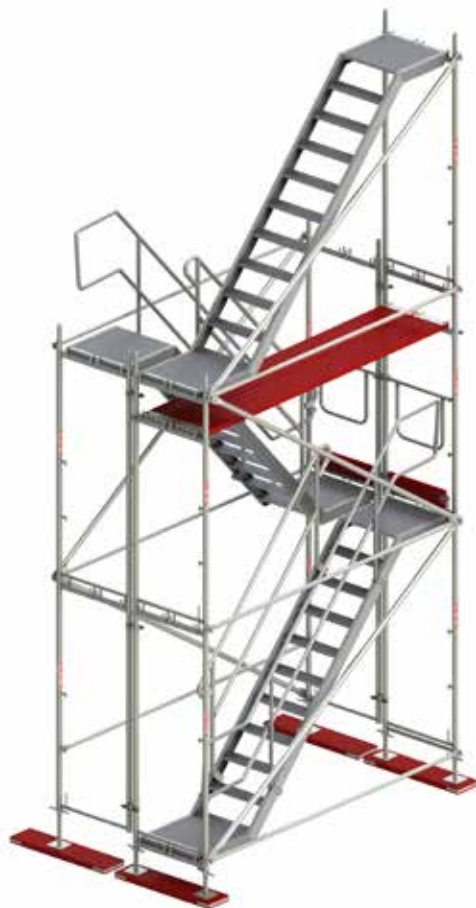
Rys. 44. Montaż klatki schodowej etap V.
