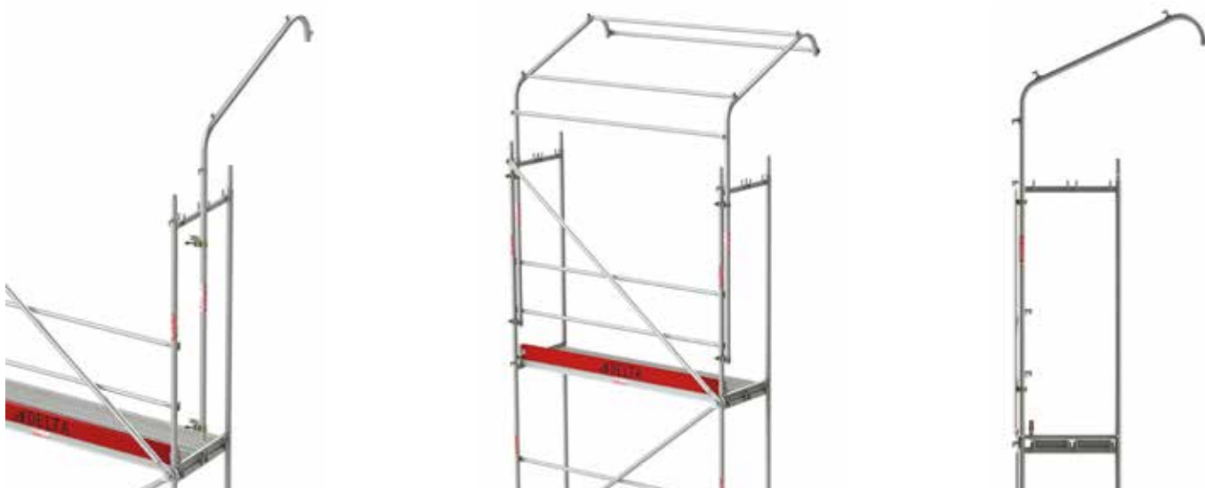
Rys. 19. Montaż słupków dachowych.
