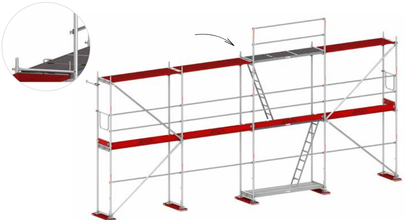
Rys. 10. Montaż słupków poręczowych z zabezpieczeniem pomostów.
